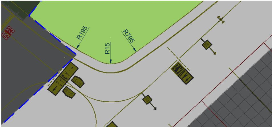
Figura 16 – Caratteristiche geometriche dell'allargamento in curva.
