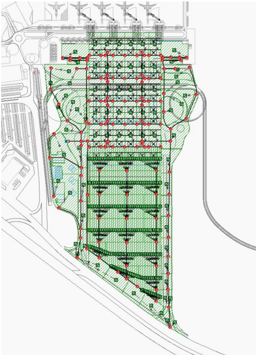
Figura 2- Schema idrografico del modello implementato su Storm and Sanitary Analysis
