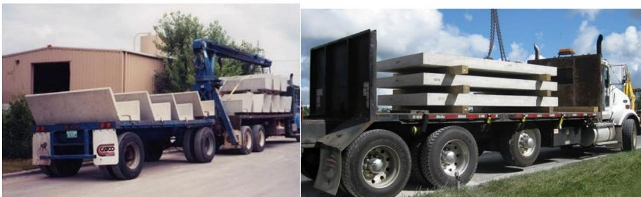
*Figura 25. Esempi di camion per il trasporto*
