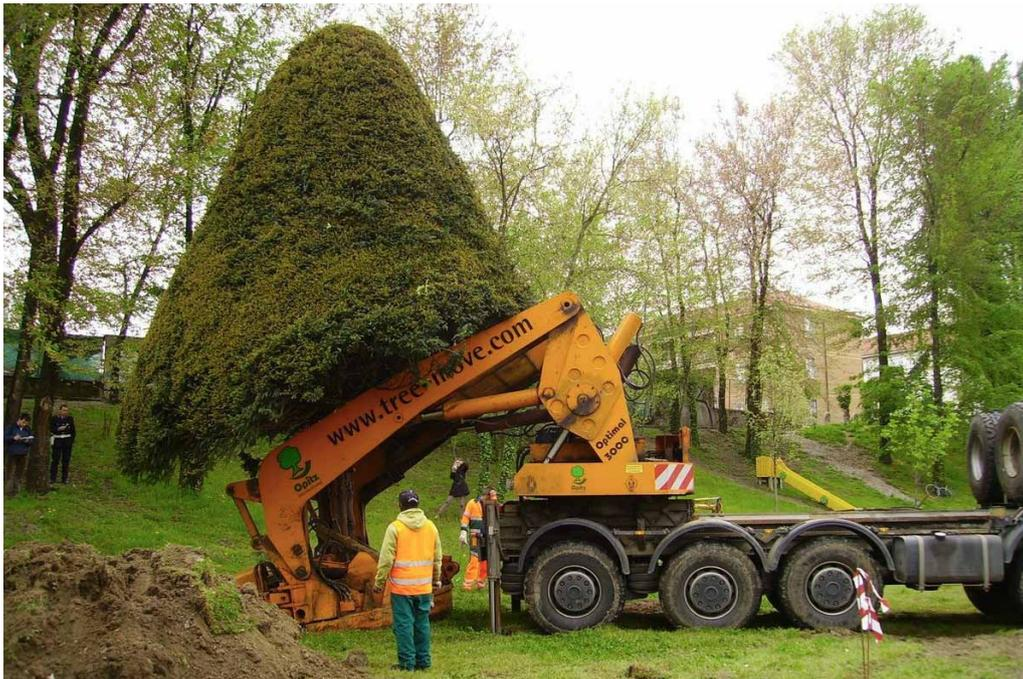
Figura 25. Completamento della formazione della zolla
