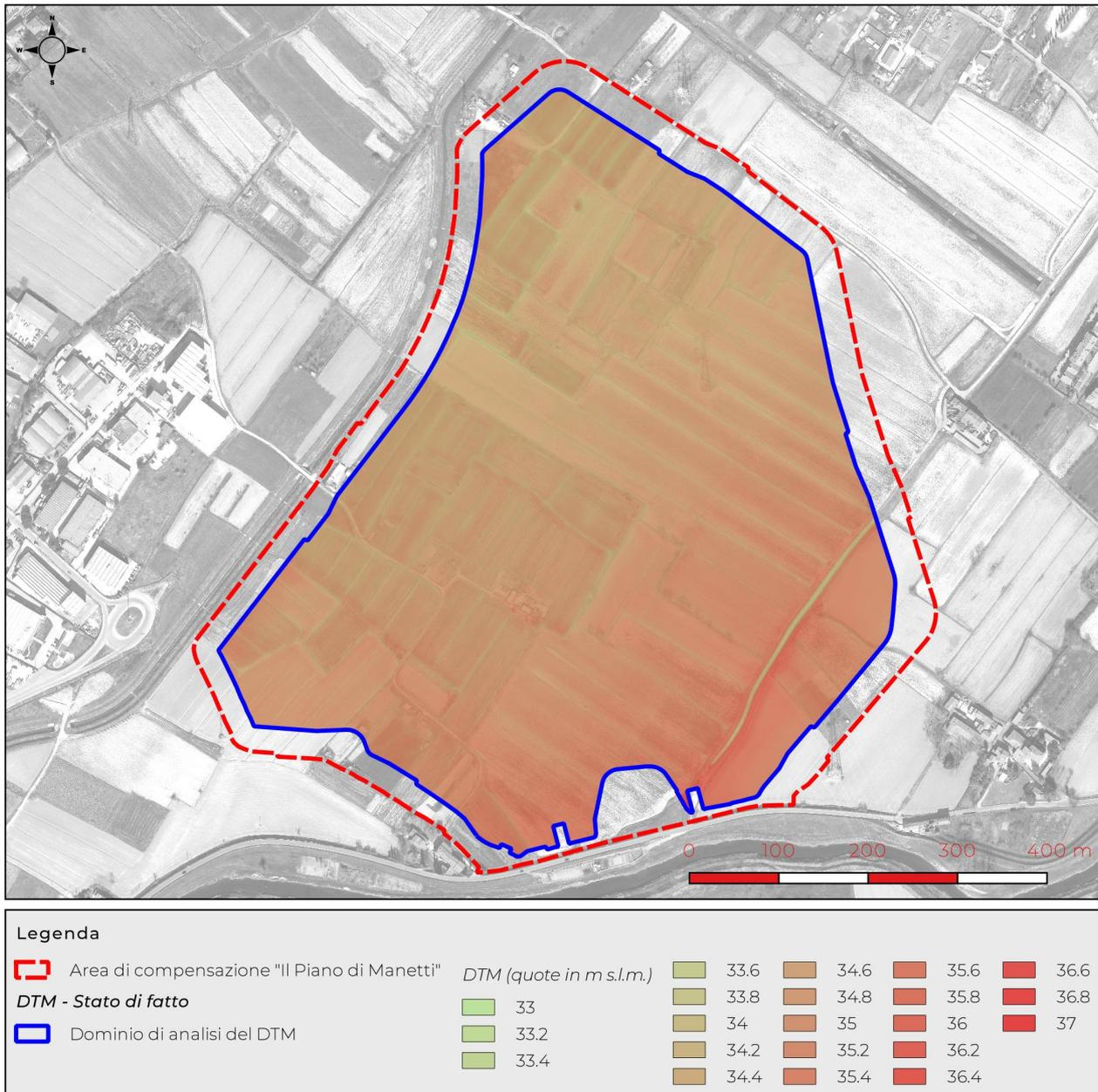
Figura 3. Visualizzazione del DTM dell'area nello stato di fatto (Fonte: elaborazione su dati Regione Toscana – Rilievi LIDAR e Regione Toscana – OFC 2K anno 2011. Licenze CC BY 4.0)
