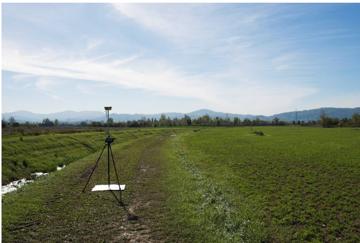
Figura 5. Ricevitore GPSS durante il rilievo delle coordinate dei punti di appoggio a terra
