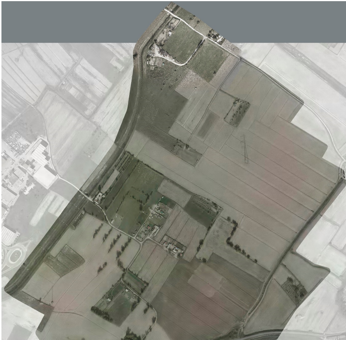
Figura 14: Unione dell'ortofoto esistente con la nuova ortofoto (nella porzione superiore) generata a seguito del presente lavoro integrativo.
