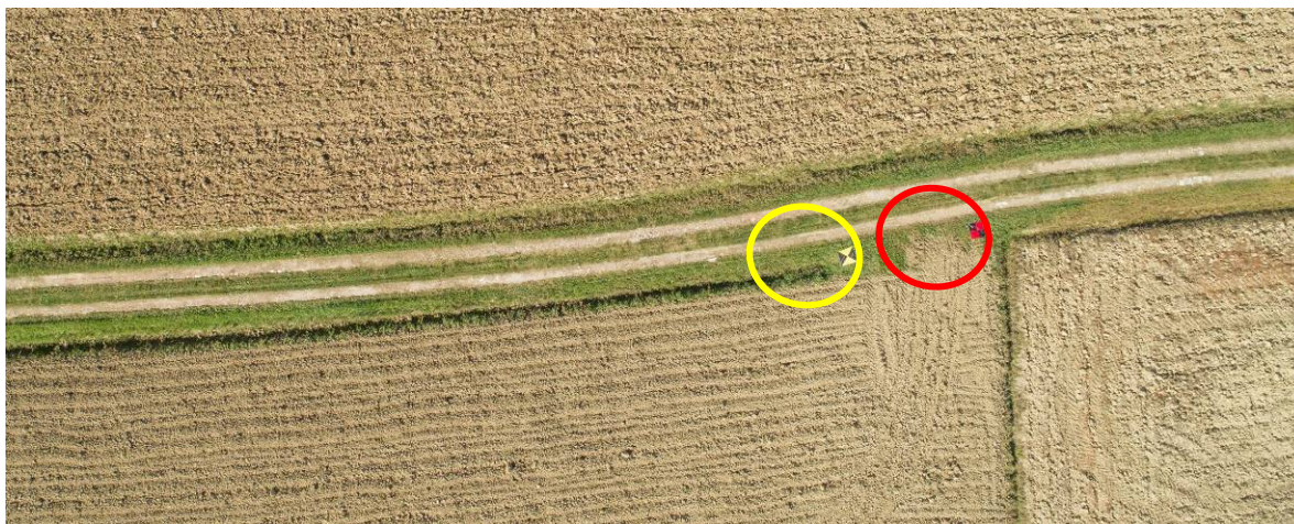
Figura 8: G.C.P. e Q.C.P. materializzati a terra con target artificiali ad alta visibilità
