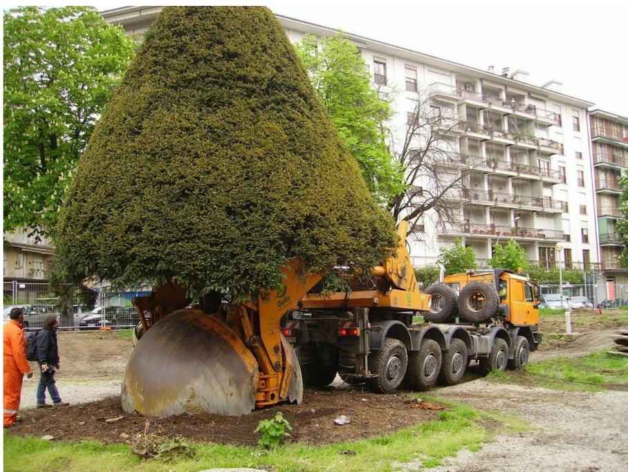
**Figura 9. Preparazione alla formazione della zolla**
