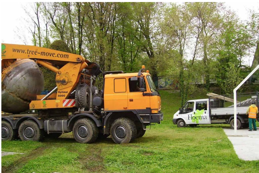
Figura 12. Sollevamento idraulico del sistema albero (parte epigea + zolla) sul pianale e avvio delle operazioni di successivo trasporto al sito di destino
