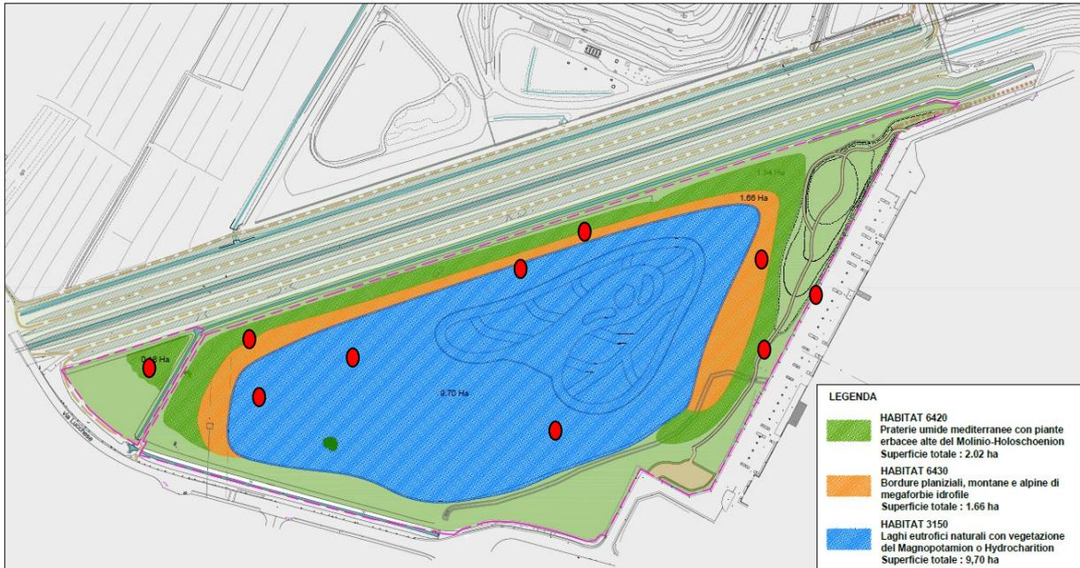
Planimetria di progetto dell'area di compensazione "Santa Croce" con in rosso la localizzazione dei punti di rilievo.
