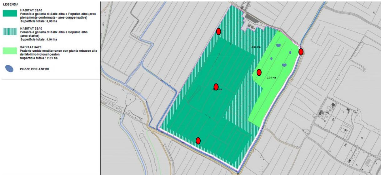
Planimetria di progetto dell'area di compensazione "La Mollaia" con in rosso la localizzazione dei punti di rilievo.
