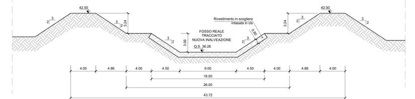
**SEZIONE TIPO MURO DI SPONDA**
