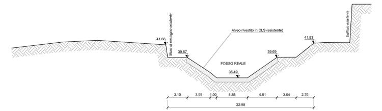
**SEZIONE B-B - RIMODELLAZIONE ALVEO ESISTENTE**
