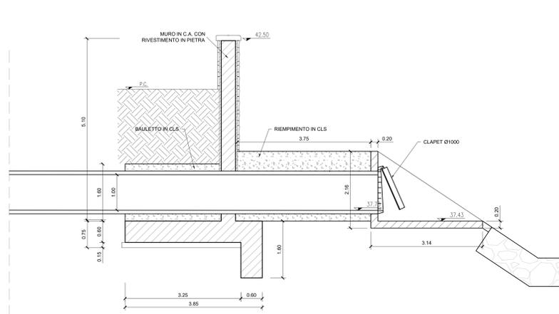
**SEZIONE TIPO MURO DI SPONDA**
