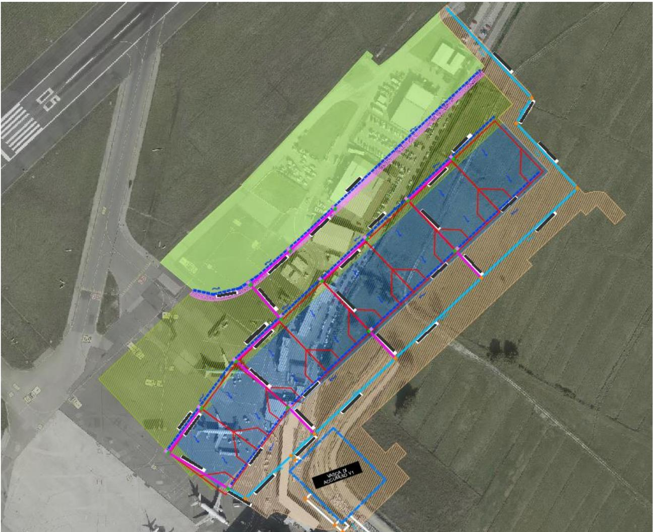
Figura 5 | Schema di drenaggio Apron 100 – Progetto del Nuovo Terminal
