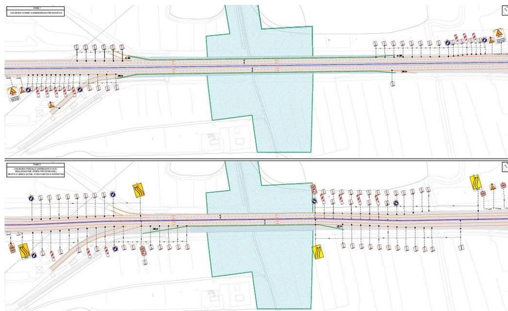
Figura 24. Attraversamento idraulico prima e seconda fase
