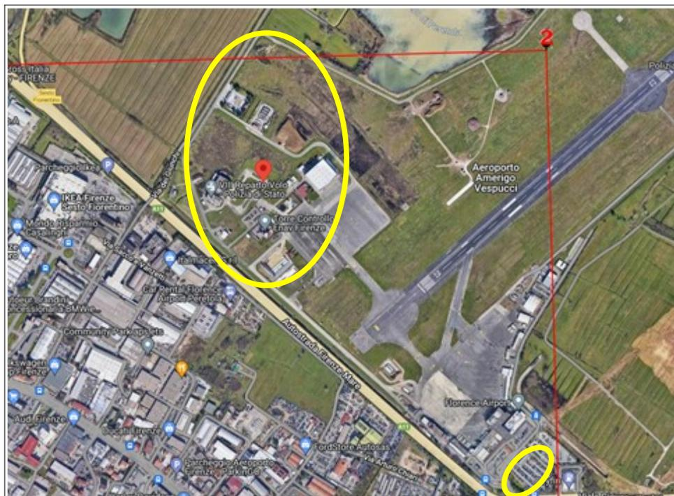
Figura 7 - Area presso la torre di controllo e area presso il parcheggio multipiano, tutti i progetti ricadono all'interno della maglia delimitata in rosso, con  $ag_{SLV}$  costante pari a 0.204g (per VN 100 anni e Classe d'uso IV)
